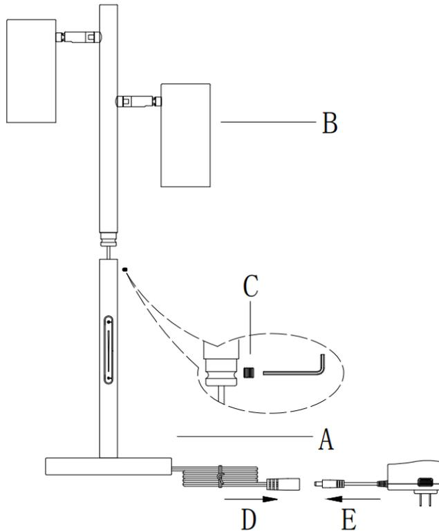
1. Replier l'excès de cordon et l'insérer dans le tube (A).
